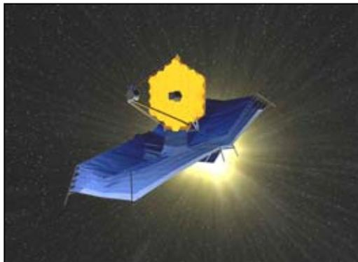
*Projet de télescope spatial JWST à miroir de 6,5 m de diamètre. Le miroir est en haut de l'image ; la structure inférieure feuilletée est un bouclier thermique. Lancement prévu après 2007. Document NASA.*
